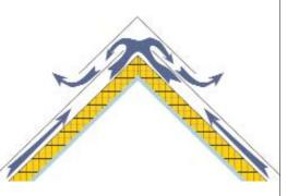
Движение воздуха во всем подкровельном пространстве наилучшим образом обеспечивает сплошной вентиляционный конёк. Его можно изготовить строилельным способом, но проще приобрести готовый
