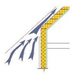
между ними минераловатные плиты толщиной 50 мм. А можно уложить тот же слой утеплителя изнутри дома - между рейками обрешетки. Именно так поступили строители при устройстве кровли над «Вестерном».
